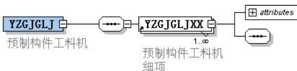
图 5.4.38 预制构件工料机元素结构关系
